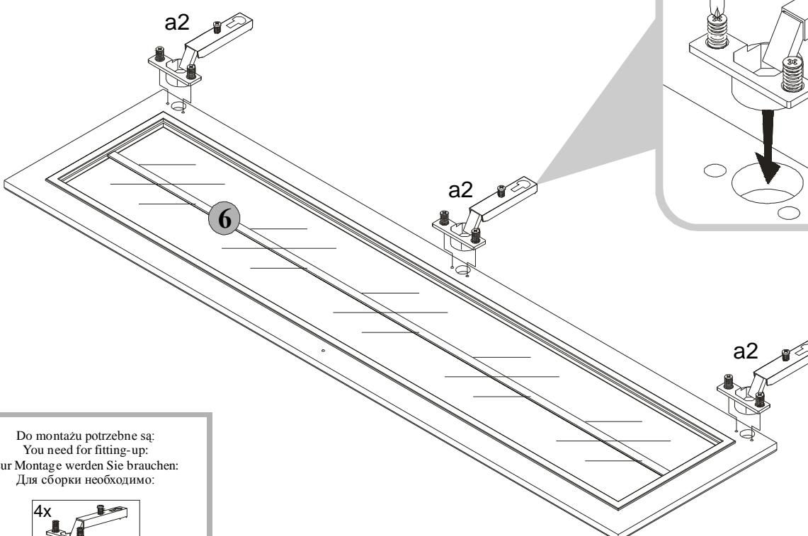
**PL** Złożyć segment zgodnie z rysunkiem i połączyc wkrętami typu konfimmat **e1**, używając do tego celu kluczyka **z1**.
