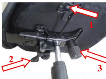
**Nastavení síly protiváhy** docílíme otáčením šroubu (3) pod sedákem - utahováním zvyšujeme sílu povolováním ji snižujeme.
