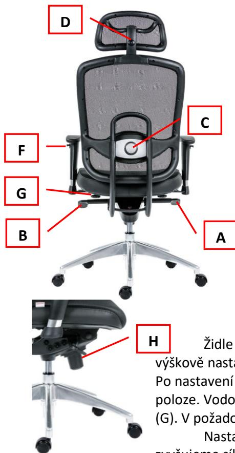
Židle je vybavena plynovým pístem ovládaným pákou umístěnou vpravo pod sedákem (A). Překlopením páky směrem nahoru se píst uvolní a lze jím pohybovat v celé jeho délce. Uvolněním páky do původní polohy se píst aretuje.
